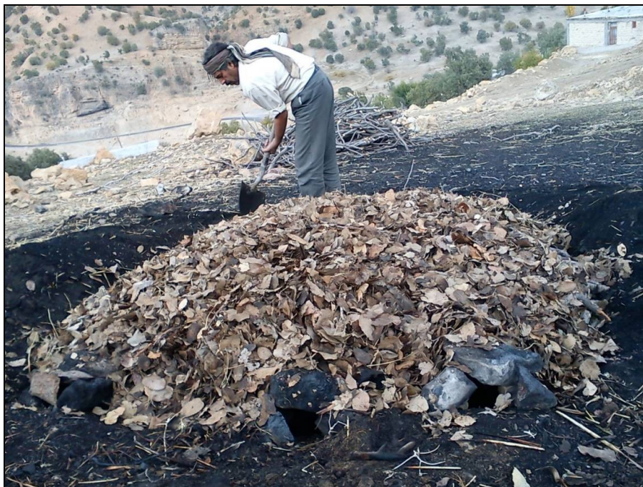
شکل ۵- پوشاندن کامل سطح چوب‌ها به وسیله برگ خشک شده درختان بلوط (منبع: پژوهشگران)
