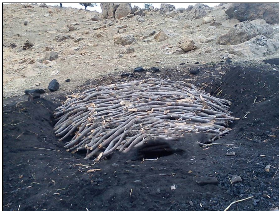
شکل ۳- مرتب کردن قطعه‌های چوب در کوره زغال‌گیری (منبع: پژوهشگران)
