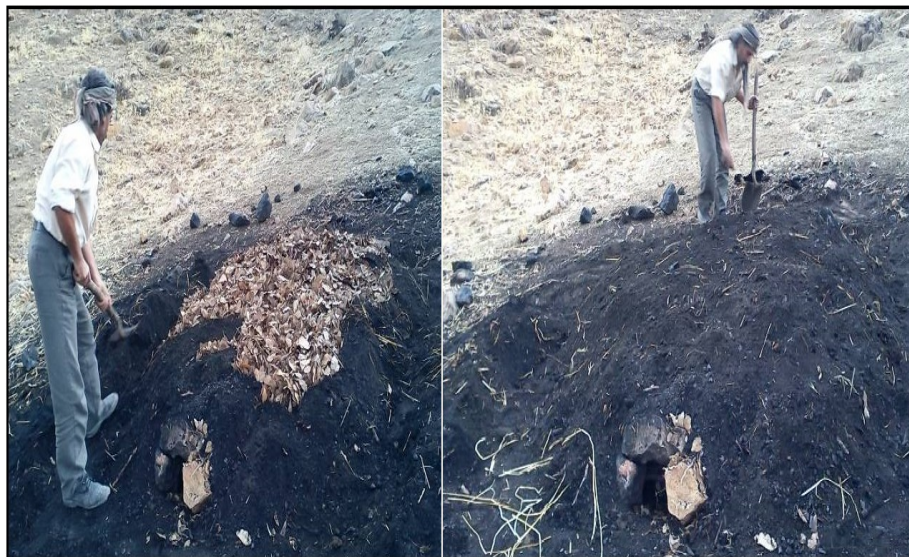
شکل ۶- ریختن خاک یا خاکستر روی کل سطح برگ‌هایی که روی قطعات چوبی گذاشته شده‌اند. (منبع: پژوهشگران)
