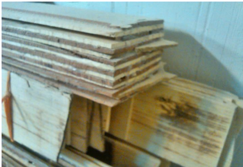
تصویر ۷- پرس و چسباندن برش‌های چوب برای تهیه جوک، کارگاه نجاری استاد کاظم جوریزی، شیراز
