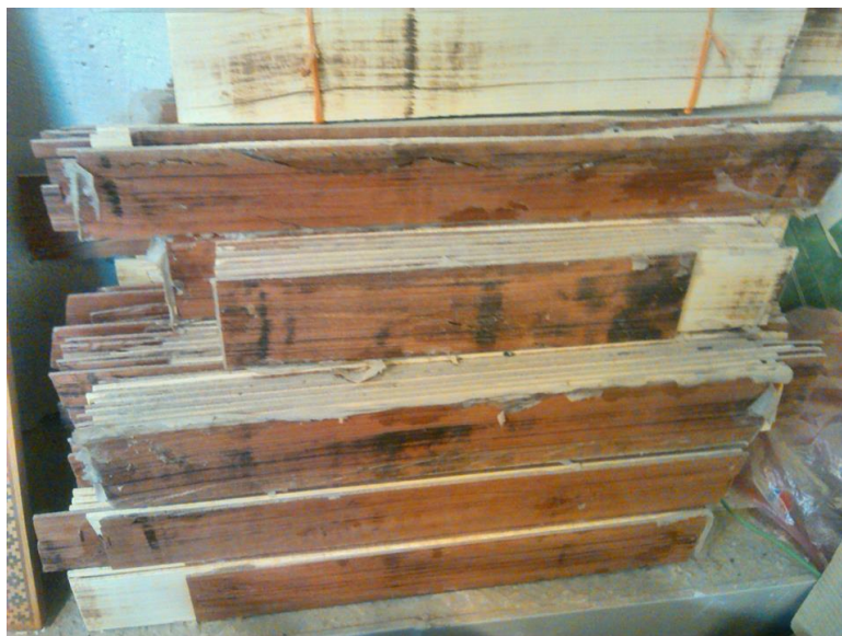
تصویر ۸- آماده کردن چوب عناب و نارنج لایه شده برای نقش و طرح موردنظر، کارگاه نجاری استاد کاظم جوریزی، شیراز
