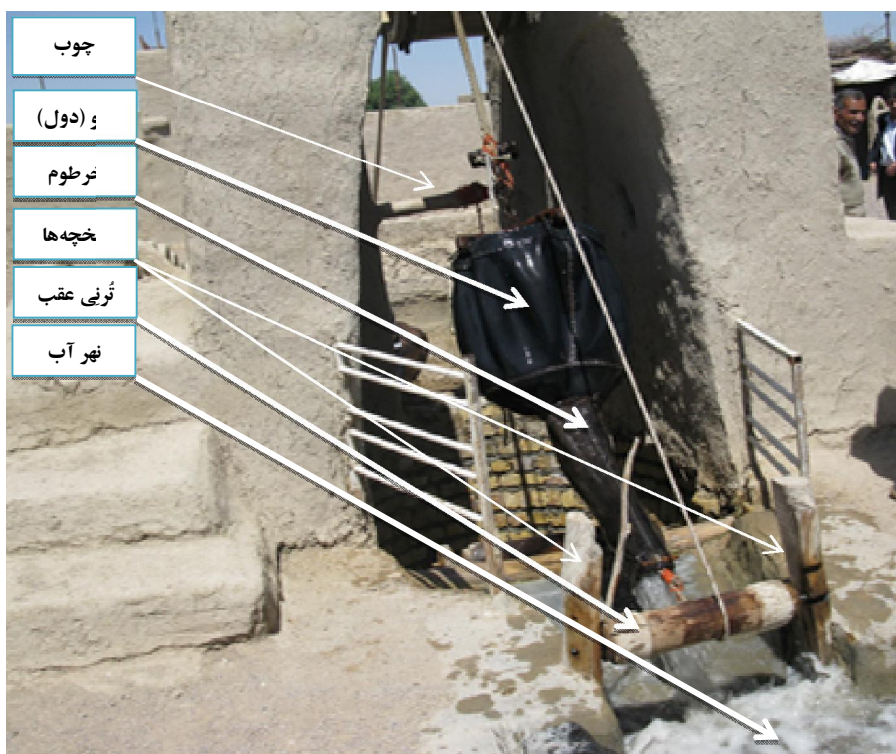
عکس ۷- اجزا و عناصر سحیل‌دهنده داوچاه در داوچاه حاج ابراهیم (رورنه)
