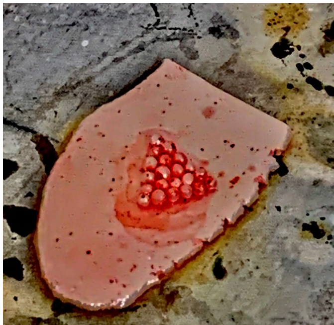
عکس ۱۹- عملیات حرارتی و اتصال گوی‌ها به سطح، منبع: (وحید قابضی)
