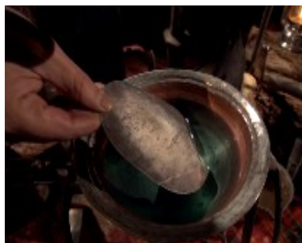
عکس ۲۸ و ۲۹- معلق کردن ورق نقره در محلول زاغ و آب (منبع: نگارنده)
