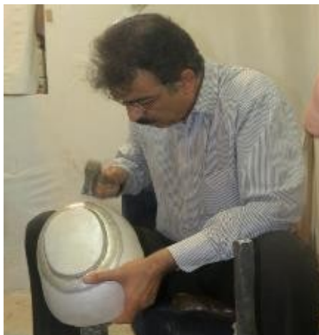
عکس ۵- هنرمند دواتگر (منوچهر دشتی نورد) در حال ساخت ظرف یک تکه (منبع: نگارنده)
