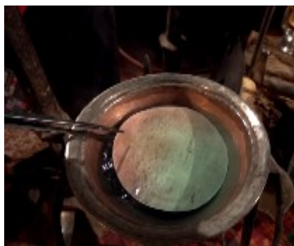
عکس ۲۸ و ۲۹- معلق کردن ورق نقره در محلول زاغ و آب (منبع: نگارنده)
