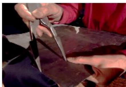
عکس ۲۴- اندازه زدن با پرگار (منبع: نگارنده)
