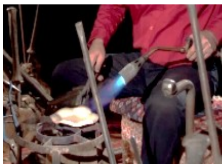
عکس ۲۷- حرارت دادن به ظرف نقره‌ای در حین کار (منبع: نگارنده)
