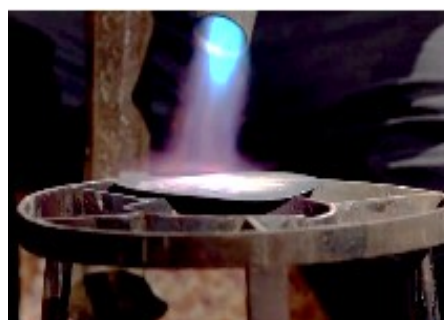
عکس ۲۶- حرارت دادن ورق برش خورده (منبع: نگارنده)
